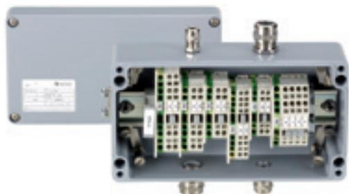
Die MULTI-BOX Exe-Klemmgehäuse entsprechen allen Anforderungen für Installationsbereiche, in denen explosive Konzentrationen von Gasen, Dämpfen und Stäuben auftreten können (Zonen 1 und 2, sowie 21 und 22).
